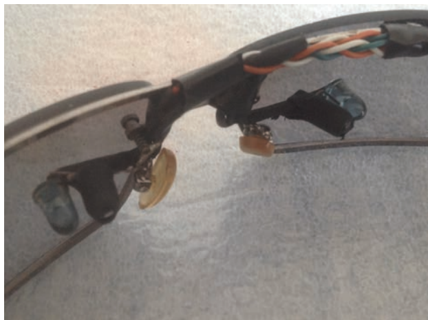
Figura 3. Diodo emisor de luz infrarroja y fotoreceptor colocados lado a lado en unas gafas.
