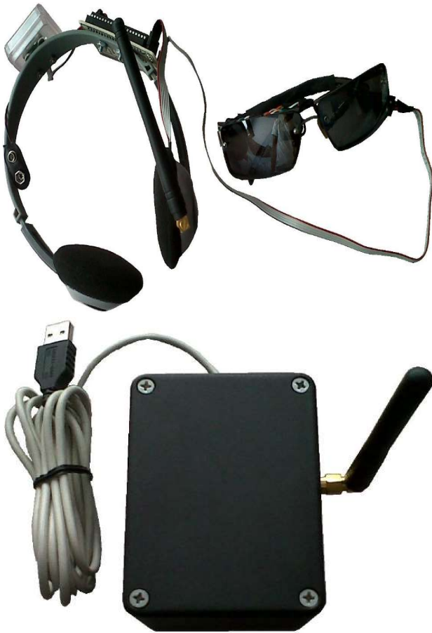
Figura 7. Interfaz final humano-computadora inalámbrica. Arriba, módulo transmisor; abajo, módulo receptor.
