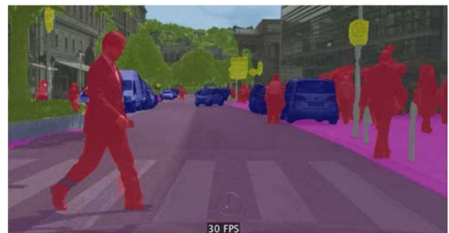
Figura 3. En un mapa semántico, además de la información geométrica, se identifican y segmentan los objetos de la escena mediante inteligencia artificial. Imagen de theaisummer.com .
