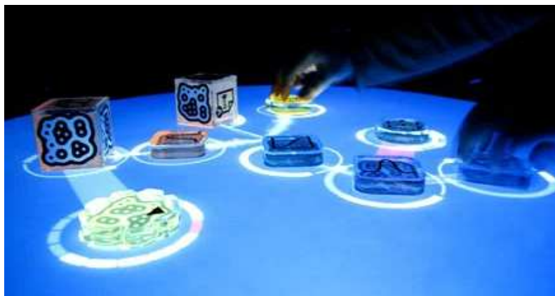
Reactable, un ejemplo de instrumento musical electrónico de interfaz de usuario tangible. Imagen tomada de: http://reactable.com/ .
